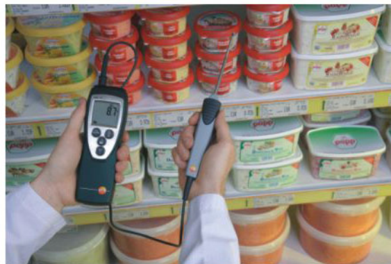
检测冷藏柜的制冷是否充分
